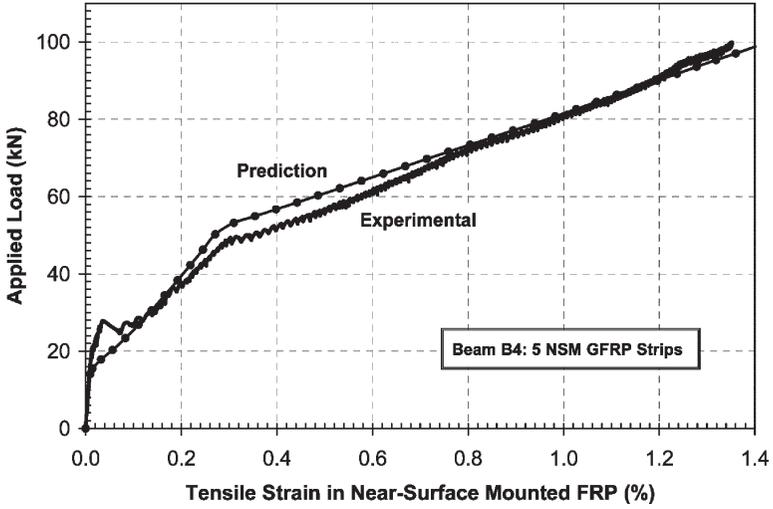
Figure 9 (d) - Load-FRP Tensile Strain Curves for Beam B4
