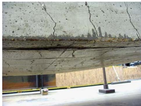
(d) Rupture of CFRP bars
