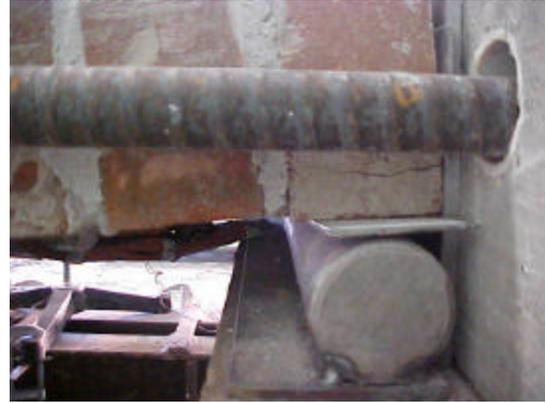
(d) Crushing of Units at Support (S12-CL5)
